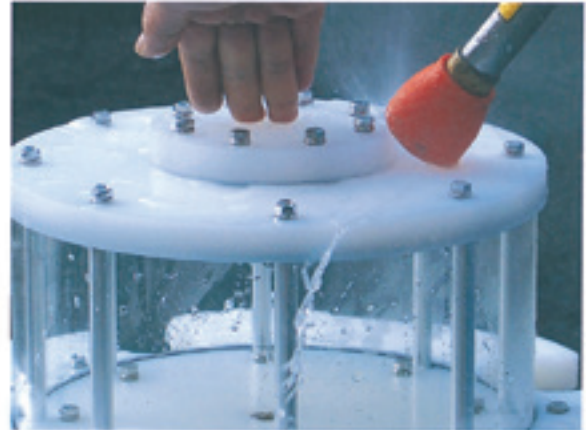
図5 ジェット噴流による耐水性能試験
